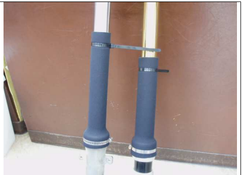
下部は、お助けマンに掴まれても大丈夫なようにステンバンド止めしてください。
