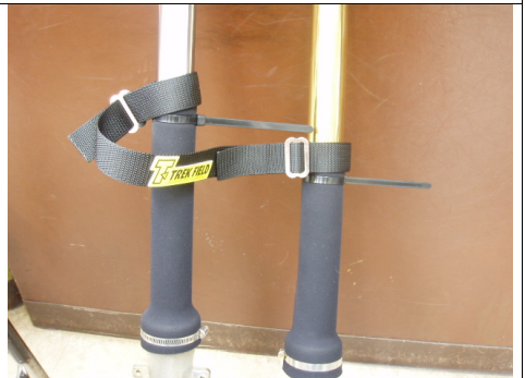
余ったタイラップのしっぽは、スタックベルトの下がり止めに活用してください。
